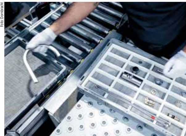
Bei der Kommissionierung wird der Armaturenkörper um die benötigten neuen Bauteile ergänzt. Das fertige Produkt erhält dann ein ReCrafted-Zertifikat
