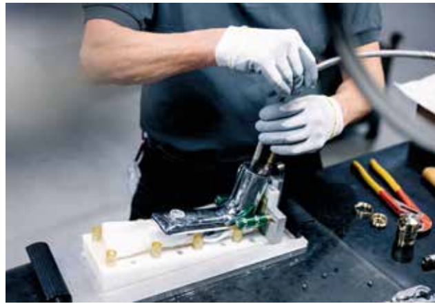
Der Prozess, den eine ReCrafted-Armatur durchläuft, ist geprägt durch handwerkliches Arbeiten und die Expertise der Fachkräfte: Im ersten Schritt wird das Produkt in seine Einzelteile zerlegt
