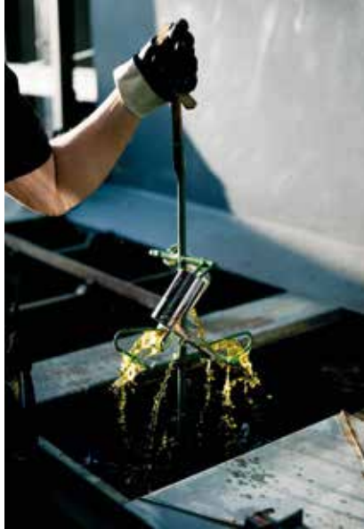
In der Galvanik wird der Armaturenkörper neu veredelt. Die entstehende Oberfläche zeichnet sich durch einzigartige Farbtiefe und Brillanz aus
