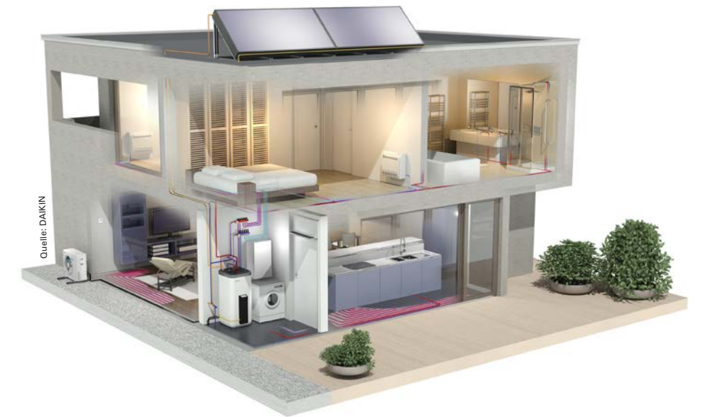
Schematische Darstellung der Funktion einer Wärmepumpe mit Außengerät (Verdampfer) und Innengeräten (Verflüssiger)
