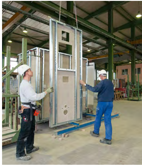
Korpusbau: Großformatige zementgebundene Massivbauplatten sorgen für Stabilität in fugenloser Ausführung
