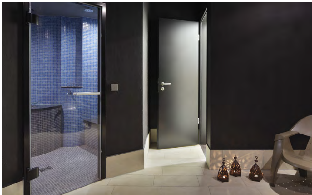
Die holzwerkstofffreien Türen im Spa- und Wellnessbereich des Hotels Oversum in Winterberg sind nassraumgeeignet, um langanhaltender und direkter Nässe ohne Schäden am Material standhalten zu können. Die Oberfläche der Türen ist besonders pflegeleicht und reinigungsmittelbeständig
