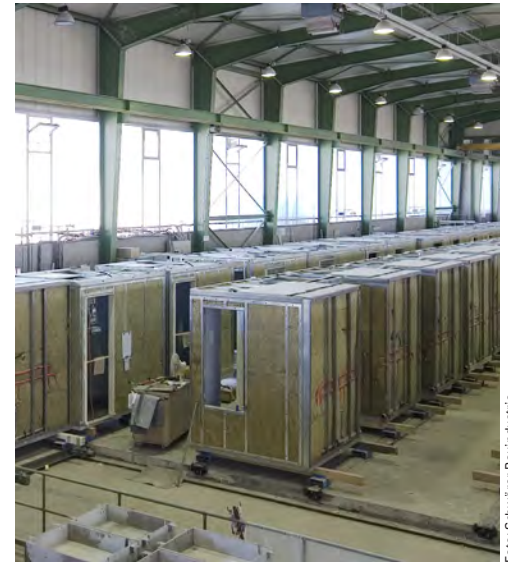
Produktionshalle: Hier kann ohne die Hektik auf einer Großbaustelle nach einem festen Ablaufplan mit allen Gewerken das Fertigbad gebaut werden
