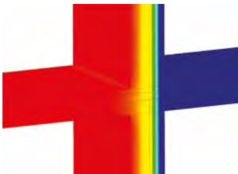
Durchlaufende Balkonplatte gegenüber Lösung mit Schöck Isokorb®, hier mit Schöck Isokorb® thermisch getrennte Balkonplatte
